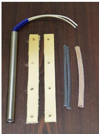
Τα μονωτικά υλικά που χρησιμοποιούμε είναι εξαιρετικής ποιότητας και απόδοσης. Δεν μπορούν όμως να ξαναχρησιμοποιηθούν. Μετά από την πρώτη έκθεση σε υψηλές θερμοκρασίες σκληραίνουν και δεν έχουν ελαστικότητα. Συμβουλεύουμε να μην ξαναχρησιμοποιείτε τα μονωτικά υλικά.
