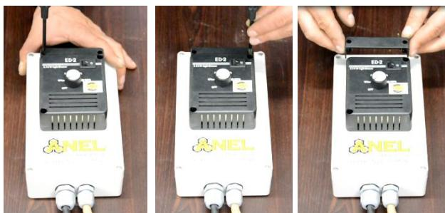
Στο κάτω μέρος του ρυθμιστή θερμοκρασίας βρίσκεται το κάλυμμα της ασφάλειας. Συγκρατείται με δύο βίδες.
