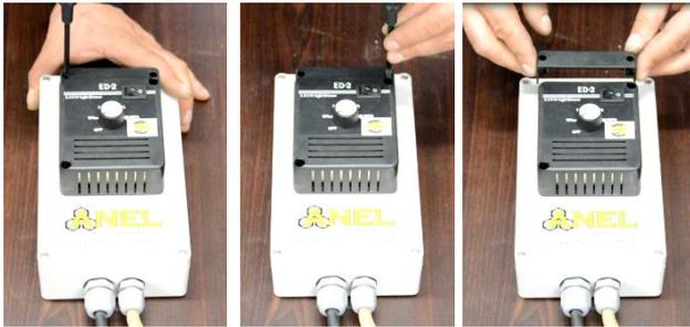
En la parte inferior del regulador de calor está la tapa del fusible. Está estabilizado con 2 tornillos. Desatorníllos y levante la tapa.
