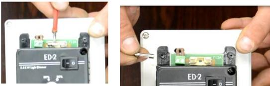
Verifica el fusible. Si necesita reemplazarlo, levántelo con un destornillador hasta que lo suelte por un lado y luego retírelo.
