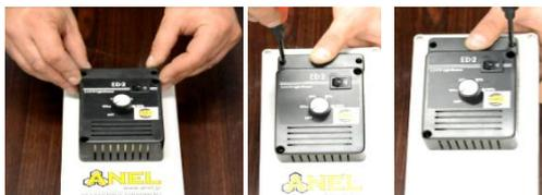
Vuelva a colocar la tapa en su lugar y atornille los 2 tornillos que la estabilizan.
