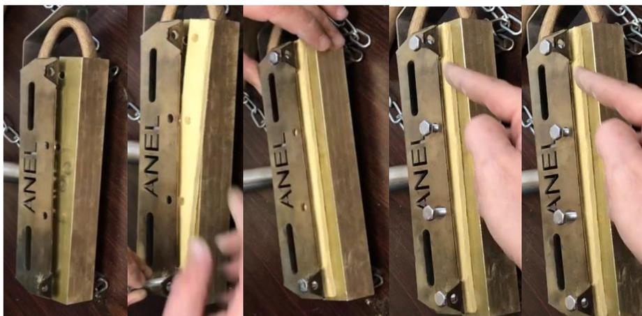
Pu Empuje la cabeza de marcado hacia atrás en su lugar e interrumpa entre los soportes de la base y el cabezal de marcado los aisladores. Tenga cuidado, el material de aislamiento es muy frágil. Inserte los 4 tornillos.
