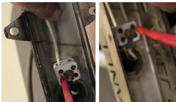
Conecte los bordes de los cables con las 2 ranuras del conector de porcelana.
