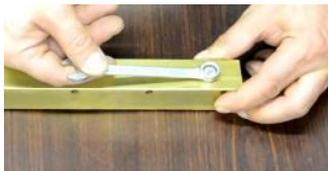
Suelte (no sacar) el tornillo en la parte posterior de la cabeza del marcador. Mantiene la resistencia en su lugar.
