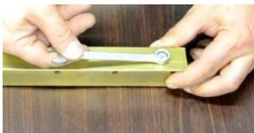
Atornille suavemente el tornillo en la parte posterior del cabezal de marcado para asegurar la posición de la resistencia en el interior. No coloque mucha fuerza o dañará la resistencia.
