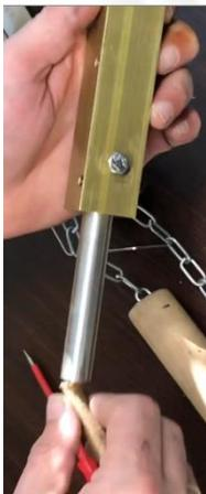
Tire la resistencia de la cabeza del marcador. Compruebe el interior del orificio en busca de restos y, si es necesario, límpielos sin dañar el latón.
