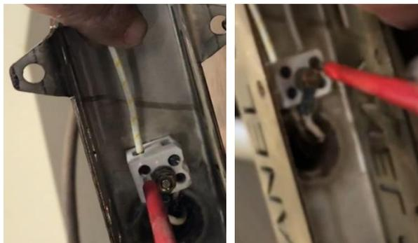
Connectez les extrémités dénudées des câbles à la connexion d'alimentation spéciale de la base. **Important ! Assurez-vous qu'aucun fil dénudé ne dépasse de la connexion, au niveau des câbles ou de tout autre point. Le contact entre les parties dénudées des câbles et toute partie métallique de l'appareil comporte un risque d'électrocution de l'utilisateur ou de l'objet à graver..**
