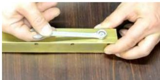
Desserrez la vis à l'arrière de la tête . Elle permet de conserver la résistance en place.
