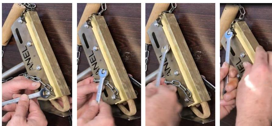
Retirez la tête de gravure en laiton de la base du pyrograveur en dévissant les 4 vis
