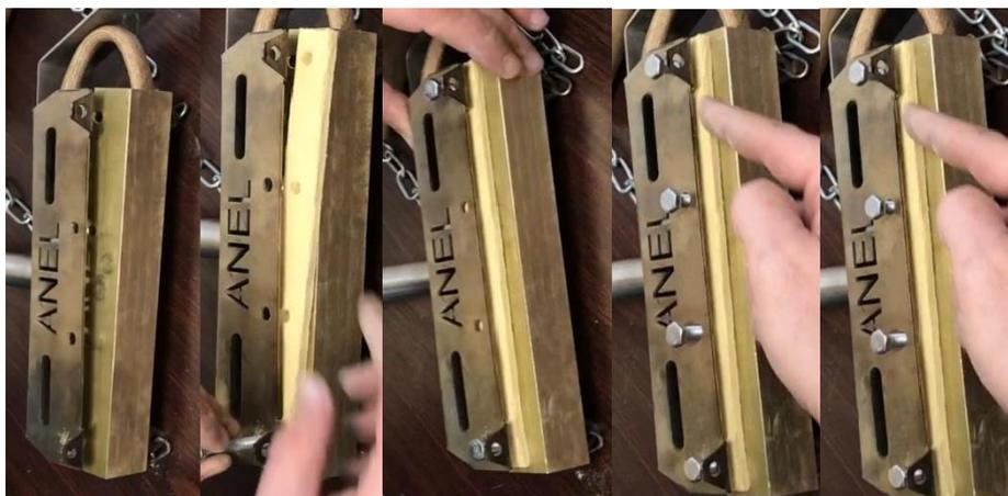
Fixez la tête de gravure dans son emplacement et insérez doucement l'isolant sur et sous la tête de gravure, et au niveau de la poignée de fixation. Attention, le matériau d'isolation thermique est très fragile. Fixez à l'aide des 4 vis.
