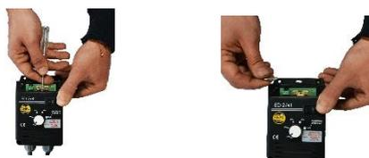
Vérifiez le fusible. S'il doit être remplacé, ôtez l'ancien fusible en le soulevant doucement avec un tourne-vis, jusqu'à ce qu'un de ses côtés soit libéré. Tirez ensuite doucement pour l'extraire.
