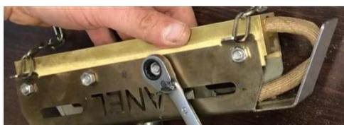
Placez les dominos électriques au niveau des vis de fixation de la tête de gravure et serrez les vis.
